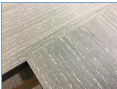
Obrázek 6/7: Rohový spoj – horní strana desky
